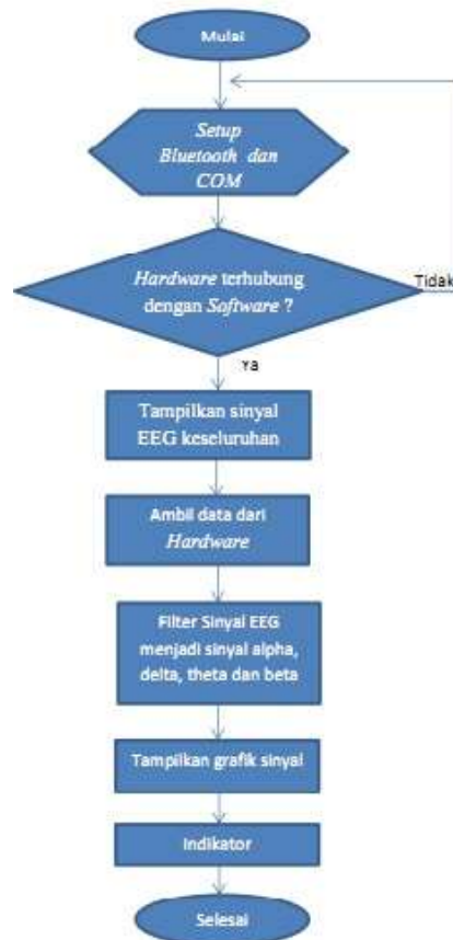
Gambar 2.3 Flowchart Indikator Sinyal
