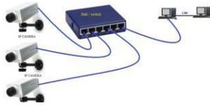
**Gambar 2.9** Konfigurasi CCTV Network<sup>[2]</sup>
