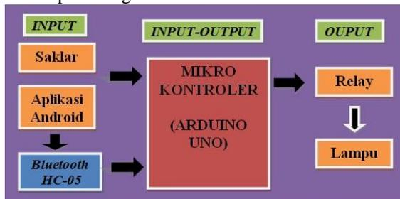
Gambar 3.1 Diagram Blok
