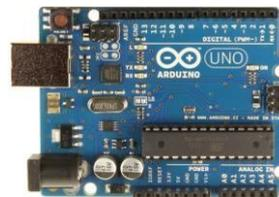
Gambar 2.1 Arduino uno<sup>[7]</sup>
