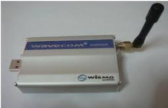
Gambar 5. Modem Wavecom
