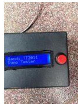
Gambar 11 Pengujian rangkaian LCD 16x2
