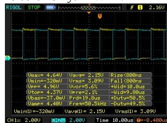
Gambar 4.1 Dua sinyal PMW dari port mikrokontroler ATmega 8535
