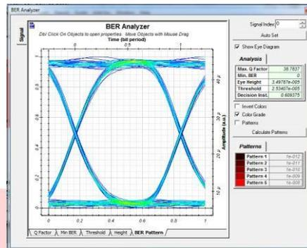
Gambar 8. BER Analyzer Optisystem pada link upstream
