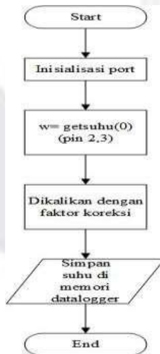
Gambar 3. Diagram Alir Program Aplikasi Pembacaan Suhu
