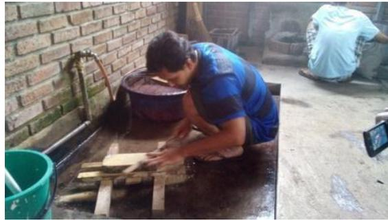
Gambar 1 Operator Mengikis Alat Cap
