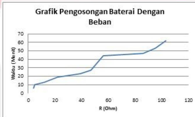
Gambar 11. Grafik Hasil Pengujian Pengosongan Baterai dengan Beban
