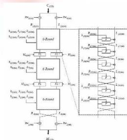
Gambar 2.5 Prosedur Dekripsi *Camellia* untuk Kunci 128 bit<sup>[4]</sup>
