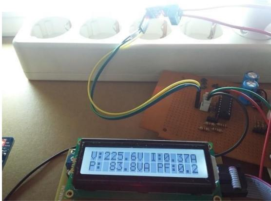
**Gambar 12 Tampilan LCD dengan beban lampu TL 18w**
