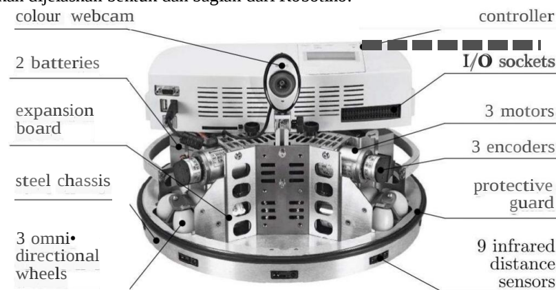
Gambar 1 Spesifikasi Robotino (Festo, 2010)
