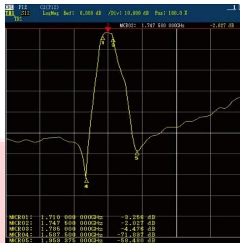
Gambar 9 Hasil Pengukuran Parameter S12 pada hasil realisasi
