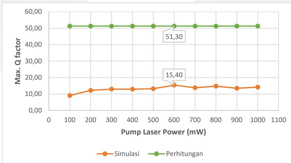
**Gambar 7 Q factor simulasi dan perhitungan (upstream)**
