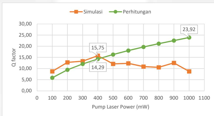
Gambar 5  $Q$  factor simulasi dan perhitungan (*downstream*)
