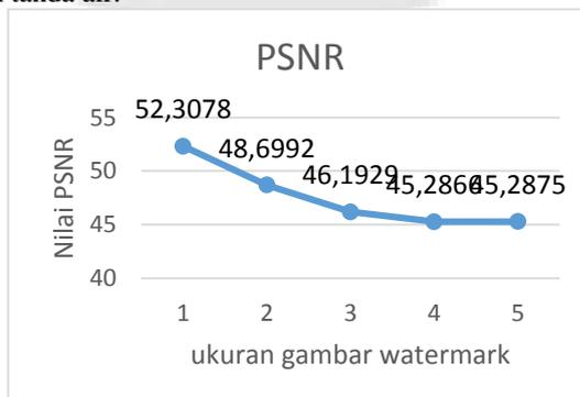
Gambar 4.4 Grafik PSNR pada percobaan watermarking gambar metode DCT
