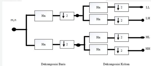
Gambar 3.4 Transformasi wavelet 2 dimensi 1 level
