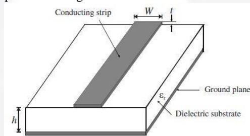
Gambar 1 Bentuk geometric dari filter microstrip [6]
