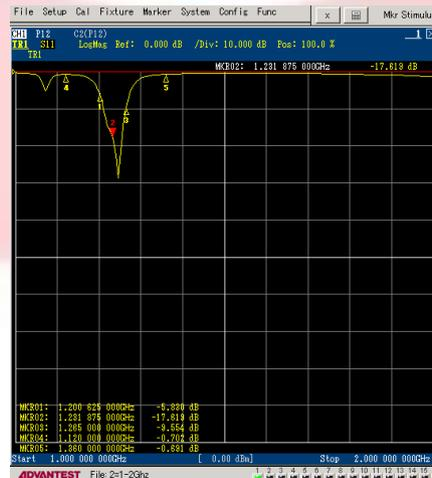
Gambar 7 Hasil Pengukuran Parameter S11 pada hasil realisasi
