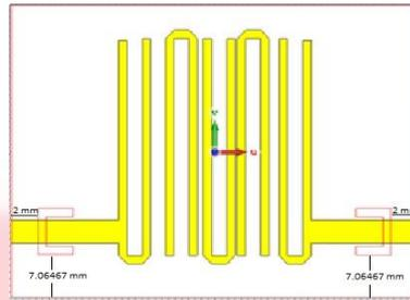
Gambar 4 Layout DGS Hairpin Line setelah dioptimasi
