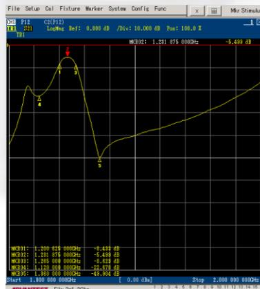
Gambar 6 Hasil Pengukuran Parameter S21 pada hasil realisasi
