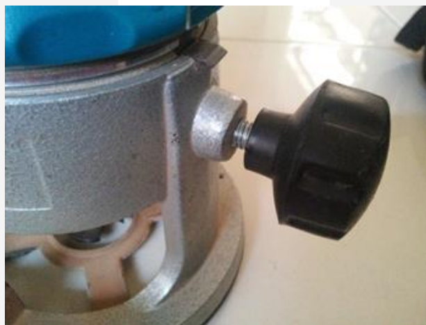
Gambar 3.1: Baut pengunci mesin profil dan penahan putaran bodi mesin
