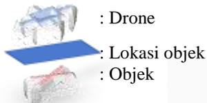
Sistem yang dibawa oleh drone akan bergerak ke udara dengan 1 putaran garis horizontal untuk mendeteksi objek. Ketinggian drone di set secara auto sehingga setelah 1 putaran ketinggian drone akan berubah.
