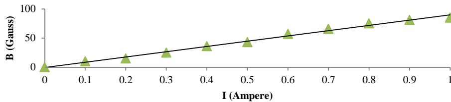
Gambar 3. 1 Grafik Besar Kuat Medan Magnet B terhadap Arus I pada jarak 1 cm untuk konfigurasi koil N 600/ L 5 cm
