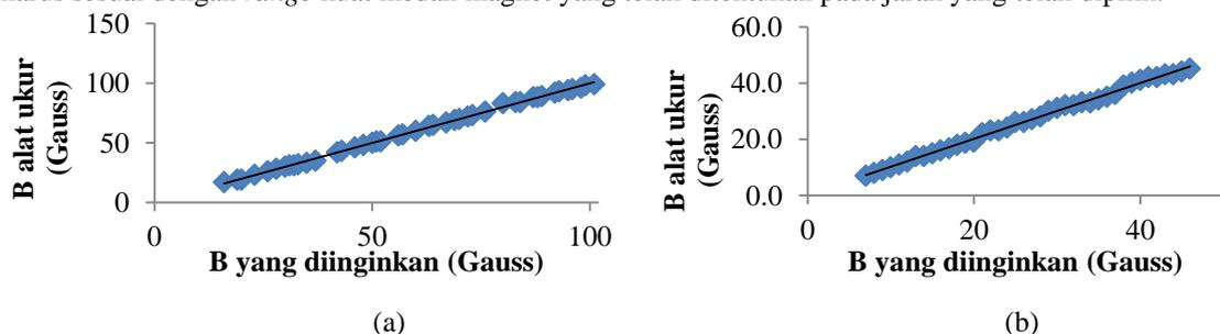
Gambar 3. 8 Grafik Besar Kuat Medan Magnet B yang Diinginkan terhadap Besar Kuat Medan Magnet B yang terukur pada alat ukur (a) pada jarak 0.5 cm, (b) pada jarak 1 cm
