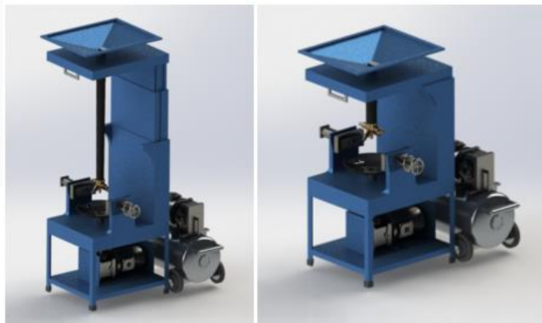
Gambar 8 Spesifikasi dan Desain Akhir Mesin Sandblasting.
