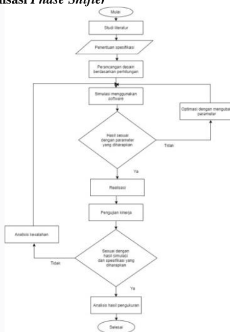
Gambar 3.1 Diagram Alir Proses Perancangan dan Realisasi Microstrip Phase Shifter
