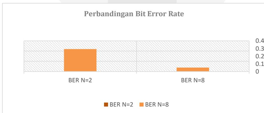
Dapat dilihat dari grafik di atas besar BER pada sistem DCT N=2 adalah 0.2930 sedangkan pada sistem DCT N=8 adalah 0.0508. Nilai BER diatas didapatkan dari hasil membandingkan hasil perhitungan menggunakan FPGA dengan MATLAB. Nilai BER pada sistem DCT dengan N=2 lebih besar dikarenakan pada sistem DCT N=2 terjadi banyak pengulangan sedangkan pada N=8, pengulangan terjadi hanya 4 kali saja.
