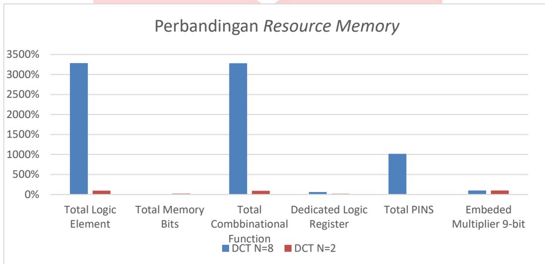
Dapat dilihat dari grafik diatas bahwa perbandingannya jauh sekali antara DCT N=8 dan DCT N=2, itu disebabkan karena kapasitas spesifikasi FPGA yang digunakan yaitu Cyclone II – EP2C20F484C7 tidak mumpuni untuk sistem DCT N=8 yang telah dibuat.
