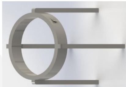
Gambar 3.5 Alat Bantu Pemasangan Pass Roll
