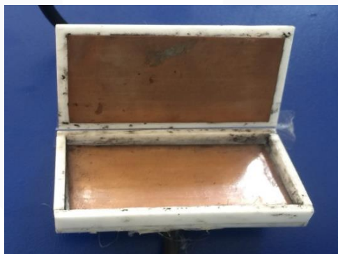
Gambar 2.2 Sensor kapasitif pada saat keadaan terbuka
