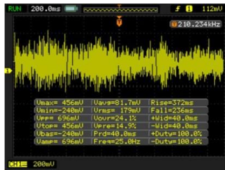
Gambar 4.3 Keluaran sinyal audio dari HDMI to RCA converter
