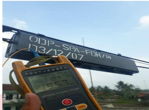
Gambar 4.2 Pengukuran core distribusi pada ODP sesuai optimasi perancangan
