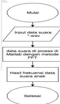
Gambar 3.2. Diagram alir pengolahan data untuk identifikasi tipe suara anak-anak.
