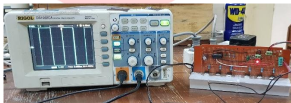
Gambar IV-4 Sinyal yang di hasilkan Inverter.
