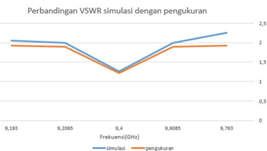
Gambar 10 Perbandingan nilai VSWR simulasi dengan pengukuran
