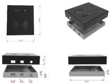
Gambar 3.3 Desain RFID Pintu Kamar Asrama
