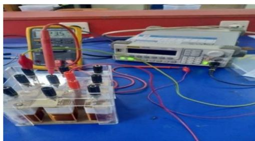
Gambar 4 Pengukuran gaya gerak listrik (ggl) induksi pada objek kosong
