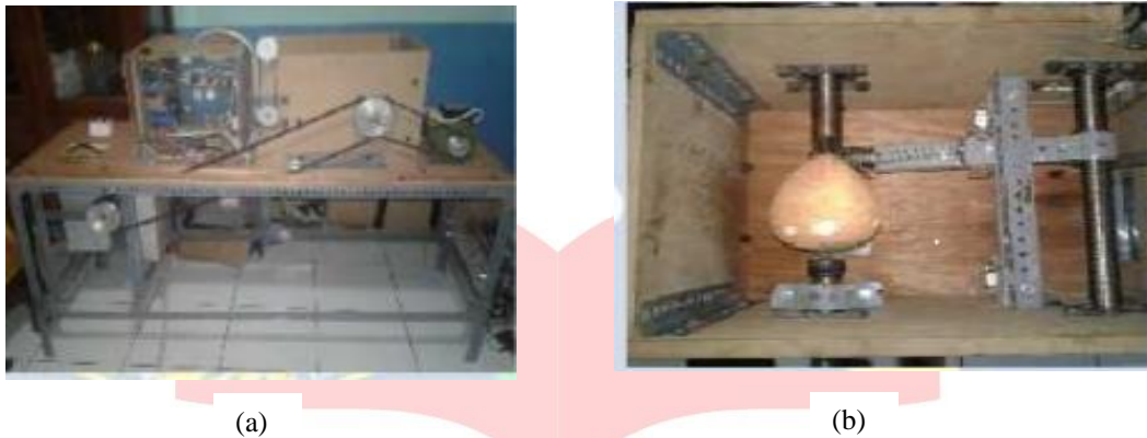
Gambar 1.1 Mesin Pengupas Kulit Ari Kelapa (a) Gambar mesin keseluruhan (b) Gambar bagian dalam mesin
