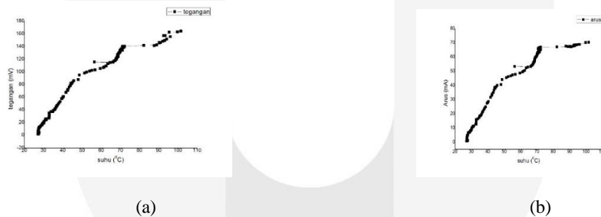
Gambar 4.3 Grafik Suhu Kompor Saat Rentang Suhu 0 – 100 o Celcius Saat Pengambilan Data dengan Menggunakan Multimeter
