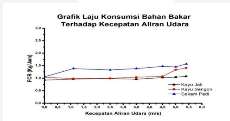
Gambar 9. Grafik FCR Biomassa ditiap Variasi Jenis Biomassa dengan Kecepatan Aliran Udara.
