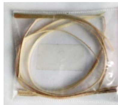
Gambar 6 Hasil Pelenturan Serat Hata
