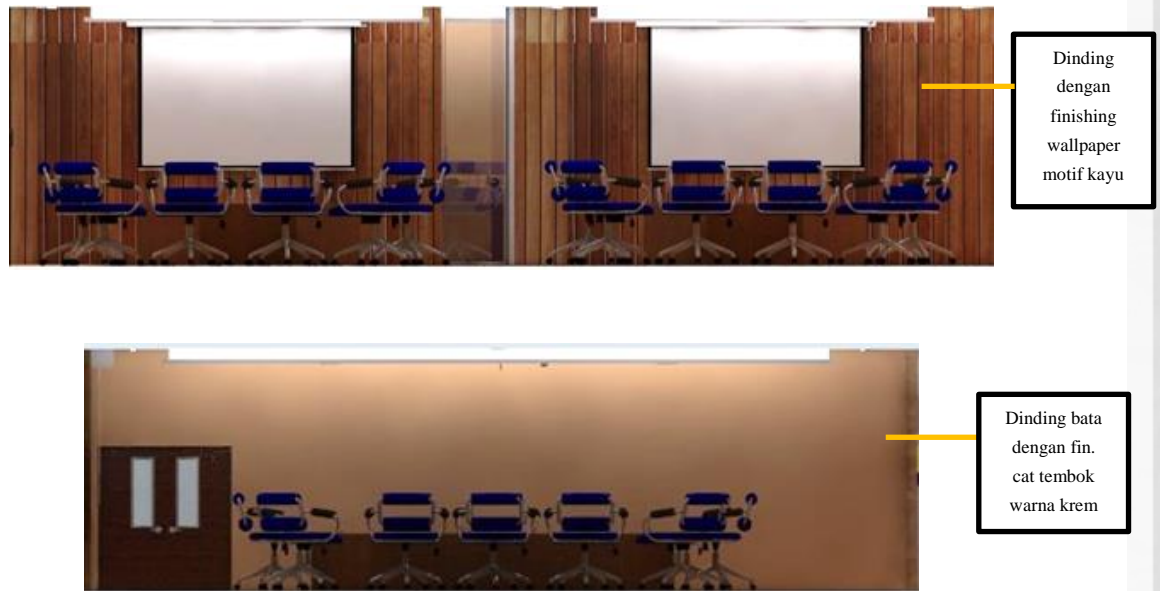
Penerapan dinding pada perancangan- Ruang Rapat
