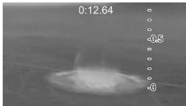
Gambar 11. Merupakan hasil dari pipet 0.3cm dengan jarak 10cm dapat menghasilkan waktu 12.64 detik, dan mendapatkan jarak pantul droplet 0.6cm
