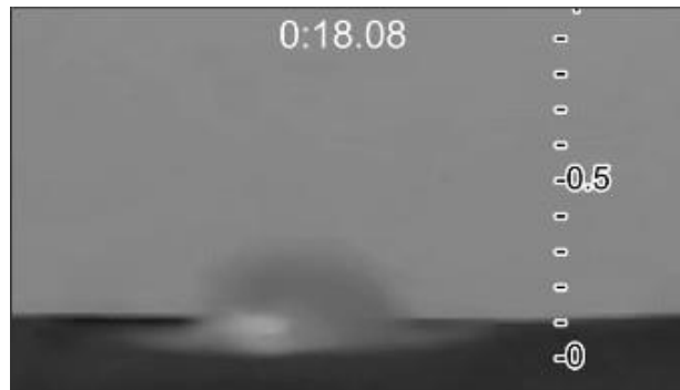
Gambar 9. Merupakan hasil dari pipet 0.1cm dengan jarak 10cm dapat menghasilkan waktu 18.08 detik, dan mendapatkan jarak pantul droplet 0.9cm
