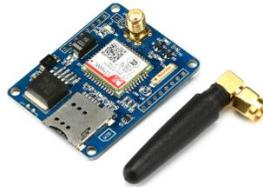
Gambar III-4 Modul SIM800C
