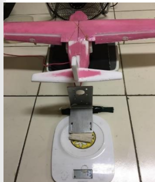
Gambar IV - 3 Pengujian Koefisien Drag
