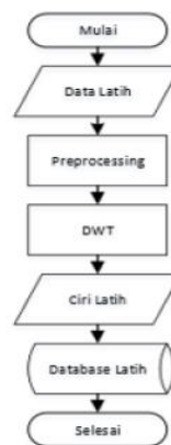
Gambar 2. Diagram Blok Ekstraksi ciri
