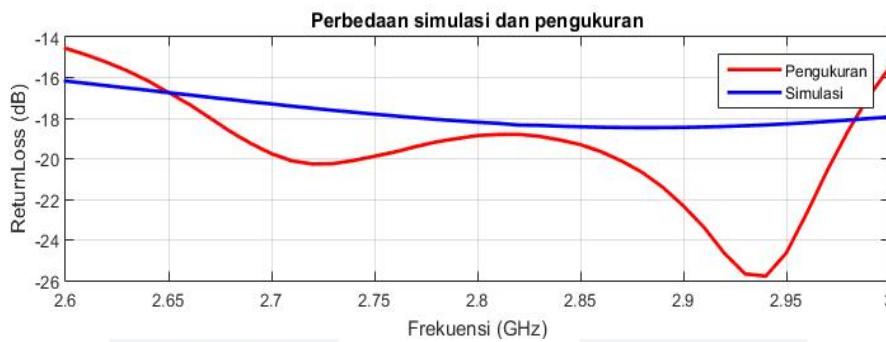
Gambar 6. Grafik perbedaan simulasi dan pengukuran return loss port 1 .
