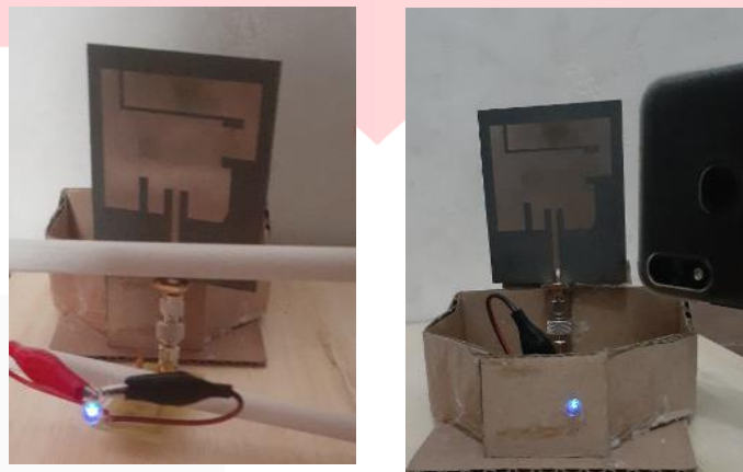
Gambar 13. Pengukuran rectenna dengan menghidupkan lampu LED tegangan forward 1.5 V.
