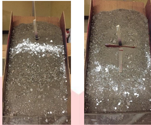
Gambar 6. Kondisi Plant sebelum dan sesudah simulasi Tanah Longsor.
