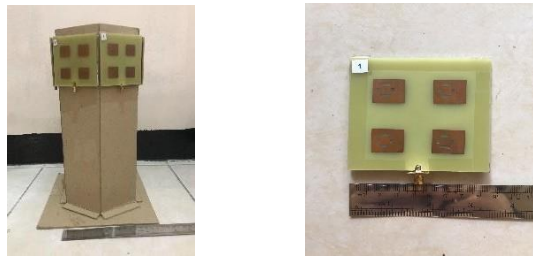
Gambar 7. Hasil realisasi antenna susun 2 \times 2 rectangular patch 3,5 GHz empat sektor.
