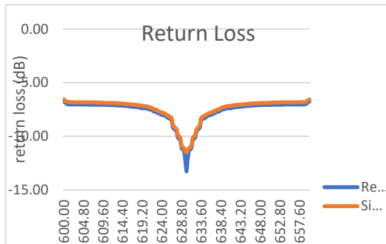
Gambar 4.2 Hasil pengukuran return loss pada simulasi dan realisasi
