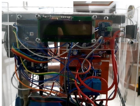
Gambar 4. 1 Implementasi Skematik Rangkaian Jemuran Otomatis
