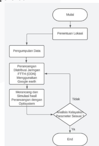
Gambar 4 Diagram Alir perancangan FTTH
