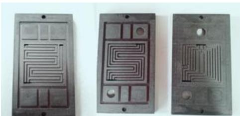
Gambar 3.3 (a) Desain Pelat Bipolar yang digunakan
