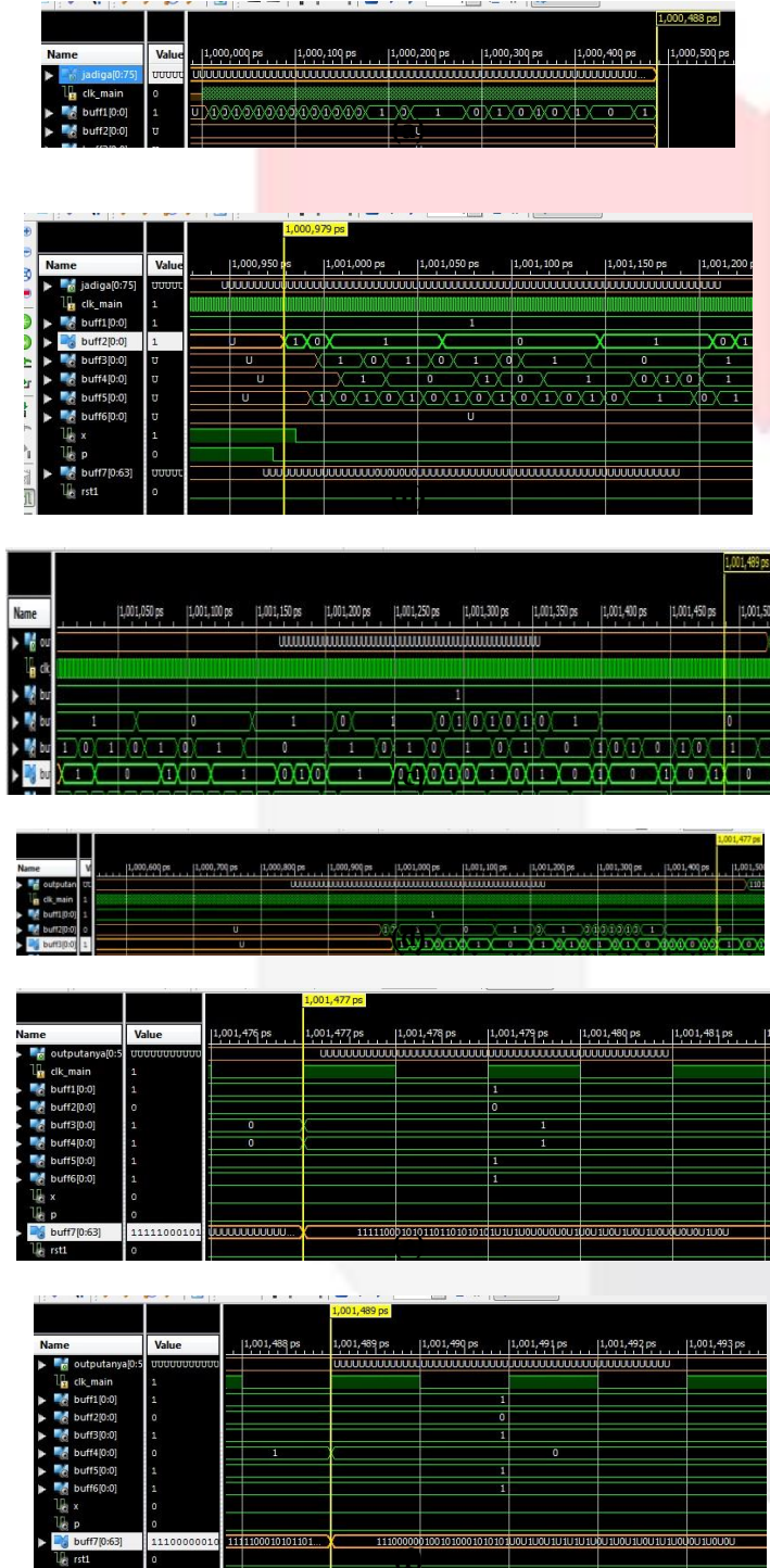
Gambar 6 Hasil Simulasi pada ISim (a) Input QPP Interleaver (b) Output QPP Interleaver (c) Output Turbo1 (d) Output Turbo2 (e)(f)(g) Output Sub-Interleaver (h) Hasil Turbo Encoder sebelum dimodulasikan (i) Hasil sintesis (j) Program sukses ditanamkan di FPGA
